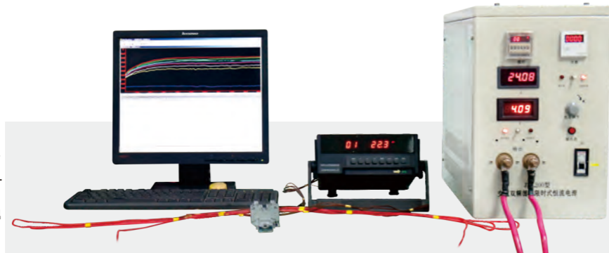
Испытание на нагрев клемм под нагрузкой
