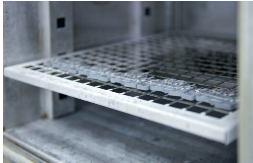
Циклические температурные испытания клемм на DIN-рейку
