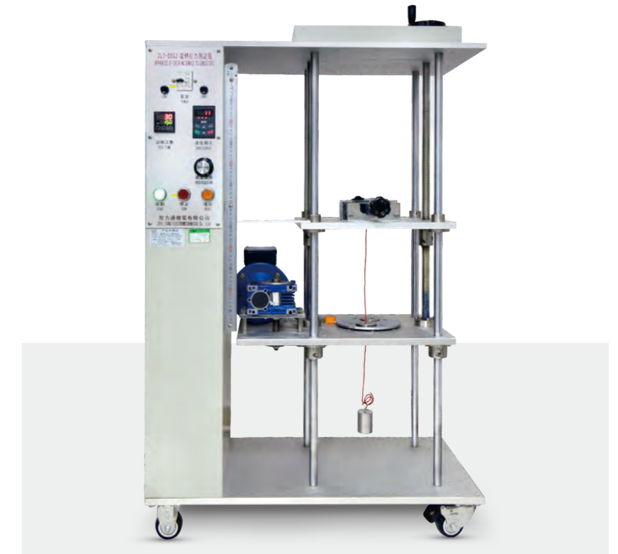
Испытания на надежность подключения в случае вращения провода в клеммном зажиме
